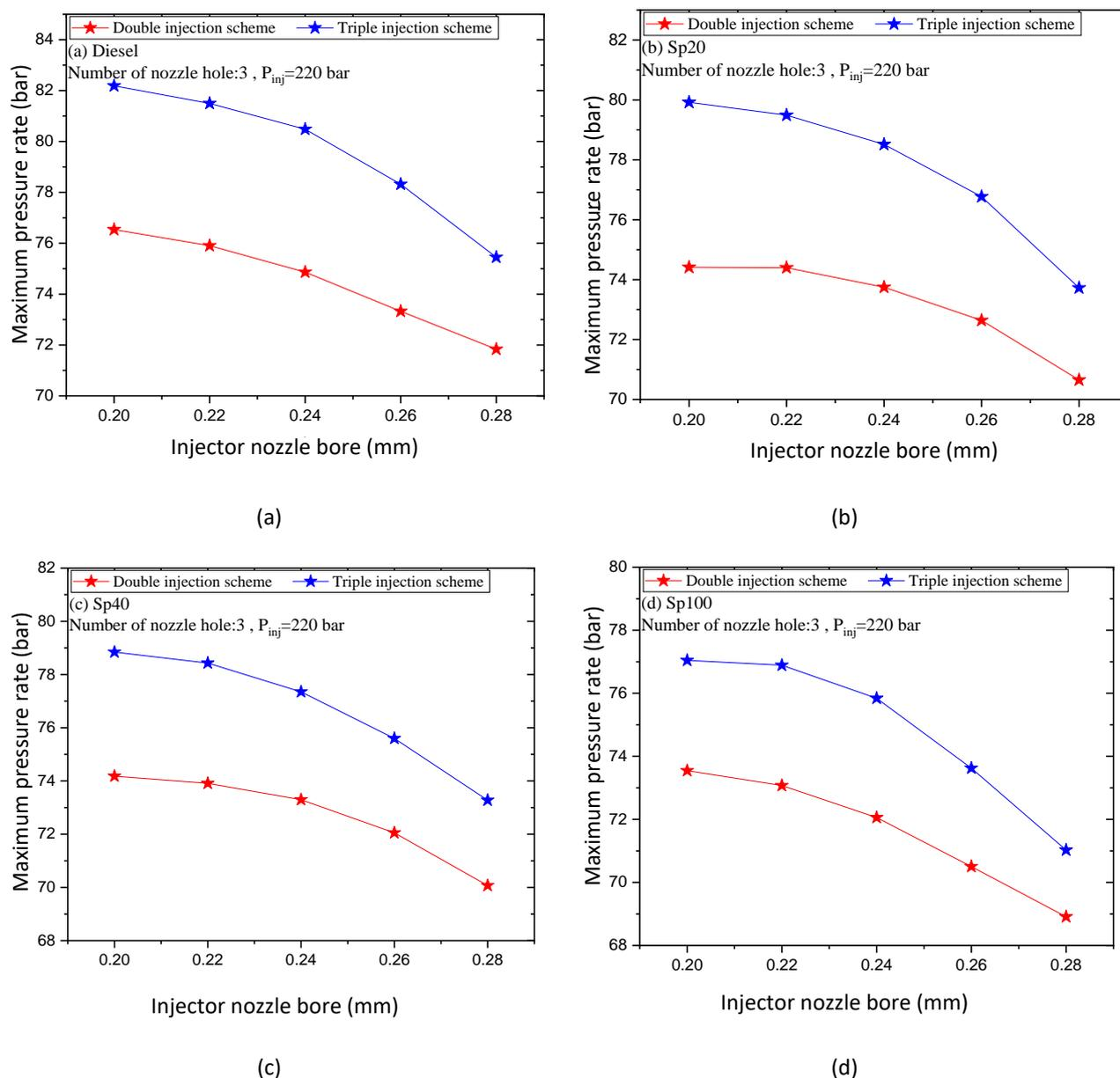
**Fig. 7.** Maximum pressure rate versus injector nozzle bore (a) Diesel (b) Sp20 (c) Sp40 (d) Sp100
