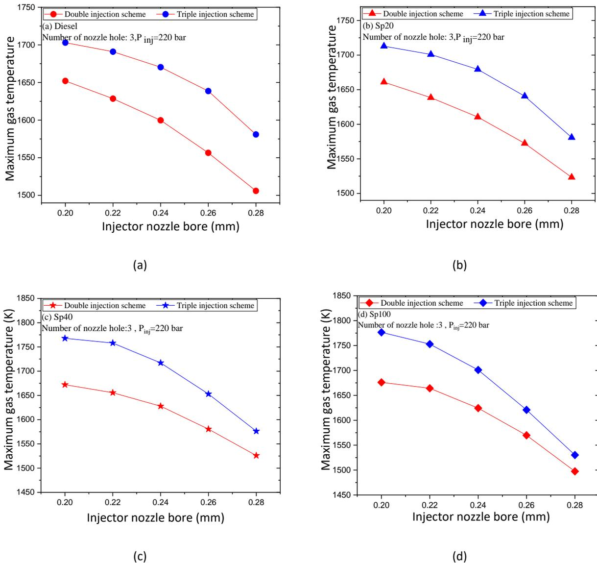
**Fig. 8.** Maximum gas temperature versus injector nozzle bore (a) Diesel (b) Sp20 (c) Sp40 (d) Sp100
