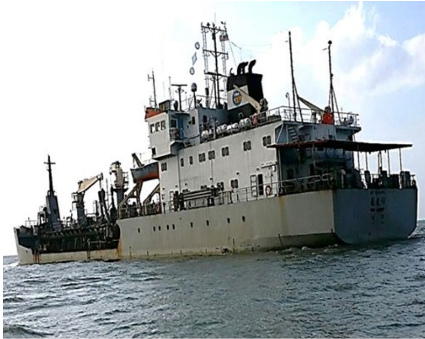
Fig. 2. Trailing suction hopper dredger (Kuala Muda, Kedah, Malaysia)
