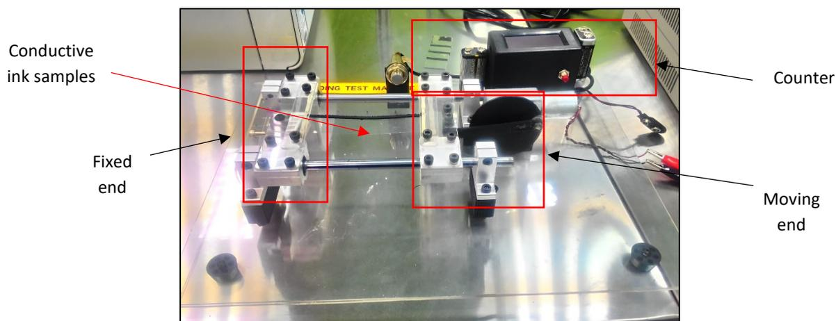
Fig. 4. Bending test rig
