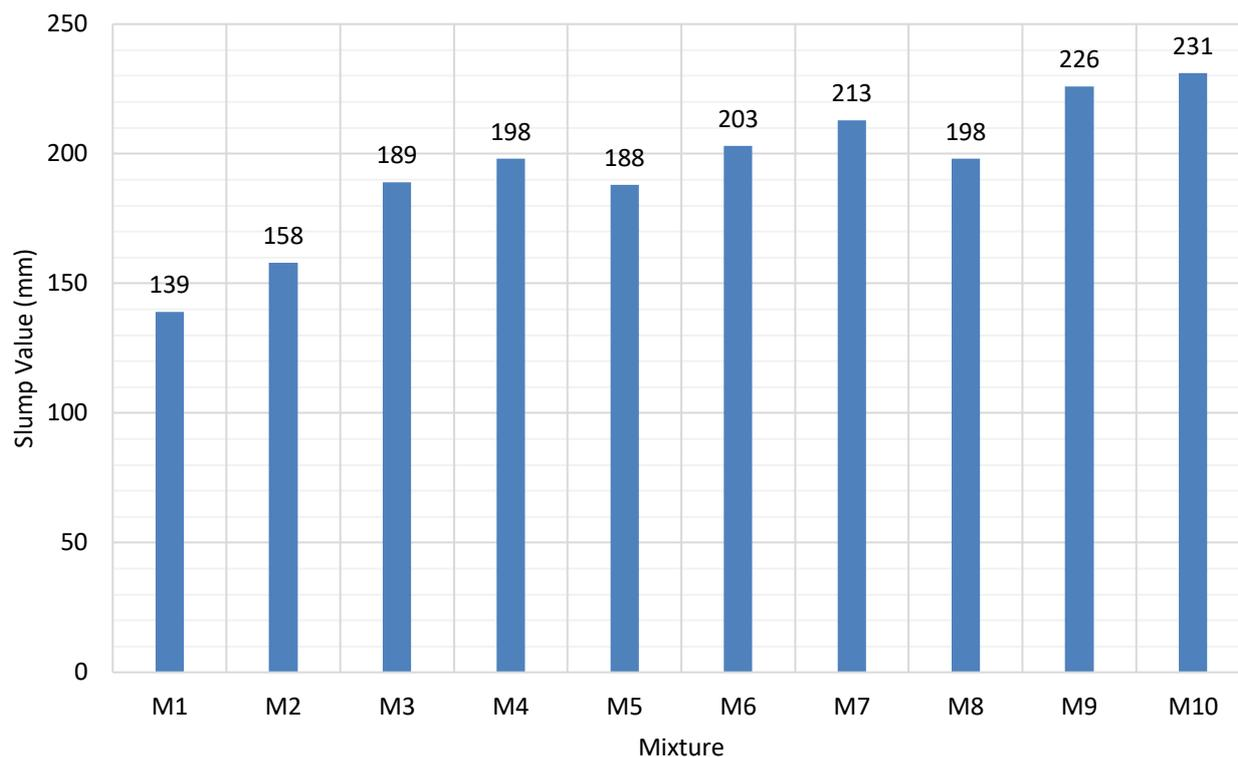
Fig. 6. Slump test
