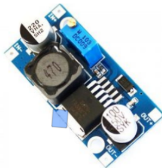
Fig. 10. DC-DC Step Up Boost Module
