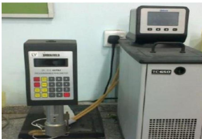
**Fig. 2.** Viscometer cone-plate
