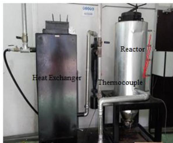
**Fig. 2.** Downdraft Gasifier
