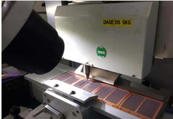
Fig. 7. Dage 4000 bond tester
