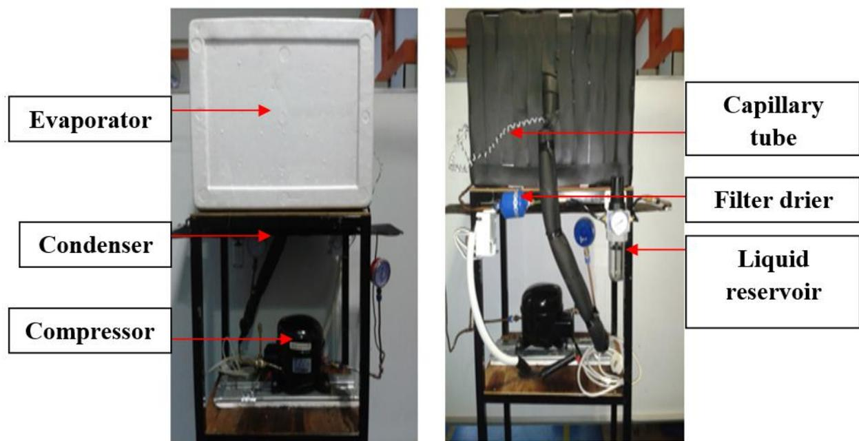
Fig. 2. Experimental test rig
