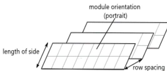
**Fig. 11.** Module layout parameters
