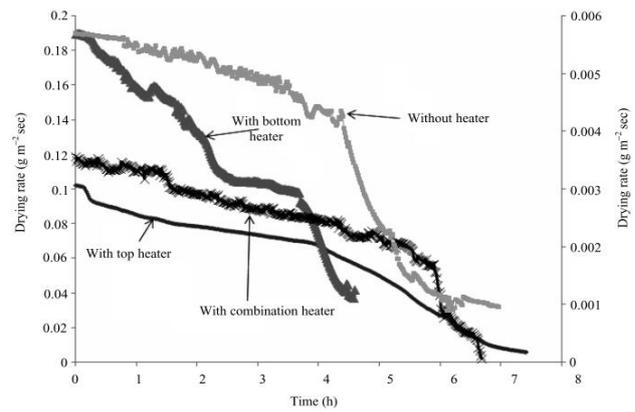
Fig. 4. Drying rate vs Time [28]
