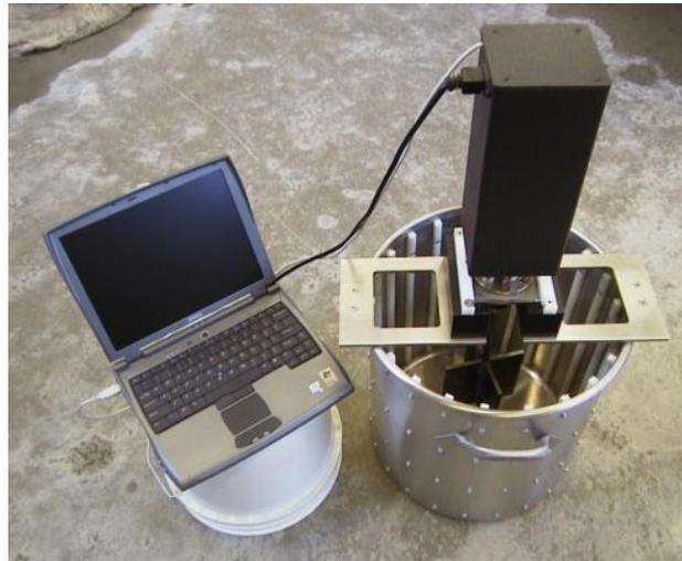
**Fig. 1.** ICAR rheometer
